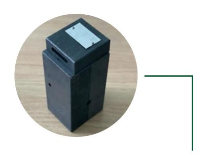
Los moldes son fabricados en grafito, diseñados para realizar diversas conexiones entre cables, platinas y varillas de puesta a tierra. Cada molde se suministra de acuerdo con las conexión requerida, diámetro de los conductores y varilla de puesta a tierra a conectar. La cantidad de soldadura requerida para cada molde varía de acuerdo con: el tipo de conexión a realizar, el calibre de los conductores y del diámetro de las varillas de puesta a tierra.
