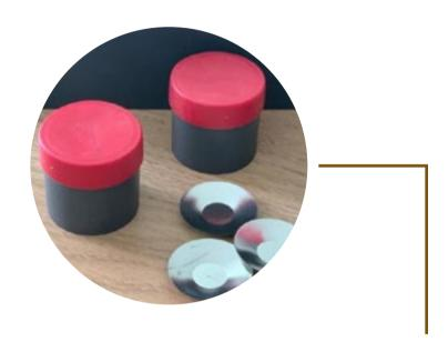
La Soldadura Exotérmica **ESTWELD®** es una mezcla de óxido de cobre y aluminio, que crea una unión permanente resistente a corrientes de falla repetidas sin deteriorarse. Se encuentra envasada en tarros plásticos individuales medidos en gramos de: 65g, 90g, 115g, 150g, 200g y 250g. Cada uno contiene un disco metálico y el fundente requerido.
